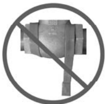
B.) Installazione errata: Nastro scaldante pencolante non aderente alla superficie
