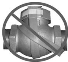
C.) Falsche Montage: Heizband überlappt sich
