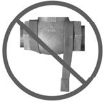
B.) Instalación incorrecta: Cinta calentadora colgando libremente de la superficie
